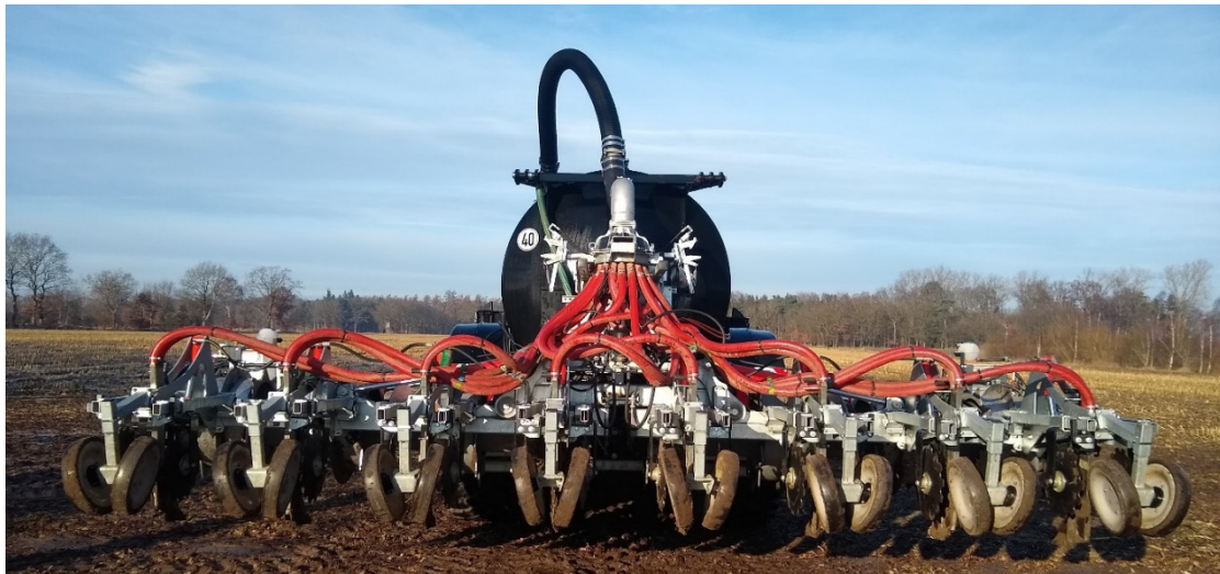
Bild 5: Streifenförmiges Applikationsgerät mit elektrisches Traktionserzeugung mittels vorgelagerter Stützorgane (Quelle: TU Dresden)
