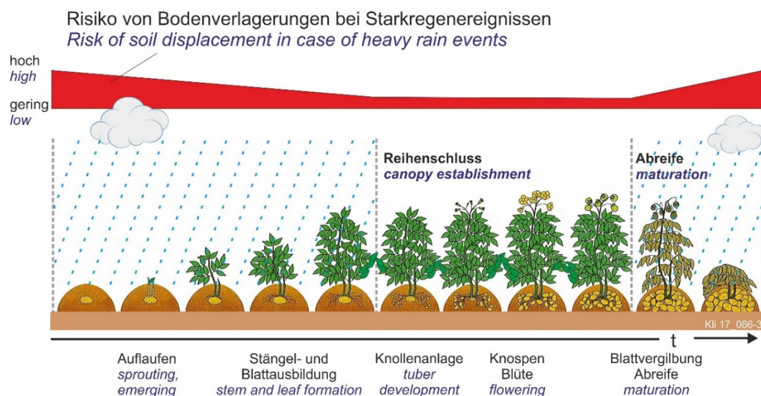
Bild 1: Risiko von Bodenverlagerungen bei Starkregenereignissen im Vegetationsverlauf Figure 1: Risk of soil displacement in case of heavy rainfall events during the vegetation period
