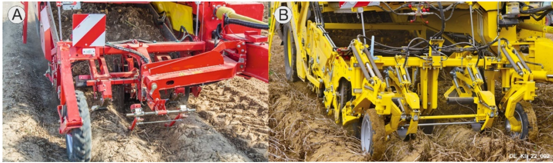
Bild 5: Gezogene (A) und geschobene (B) Aufnahme mit Tastkufen anstelle von Dammtrommeln für die Kartoffelernte auf schweren Böden. (Bildkomposition [11; 12])
