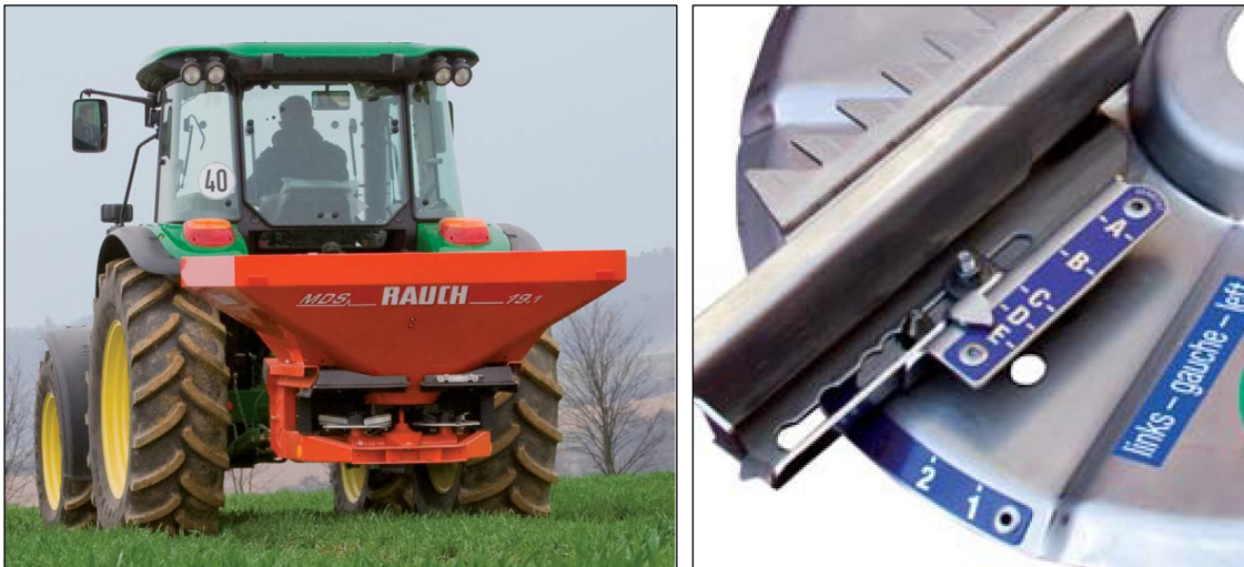
Bild 11: Zweischeibenstreuer MDS: 12-21 m Arbeitsbreite (links) und MDS-Streuscheibe mit Winkel- und Längenverstellung der Wurfblätter (rechts) [RAUCH Landmaschinenfabrik GmbH]
