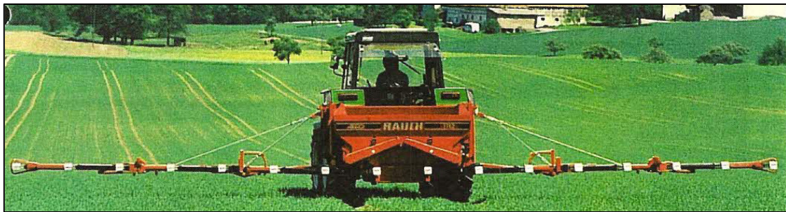
Bild 7: Rauch-Pneumatikstreuer AERO 1112: 12 m Arbeitsbreite, 1100 Liter Behälterinhalt [RAUCH Landmaschinenfabrik GmbH]
