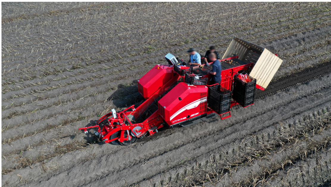
Bild 12: Funktionsmuster einer autonomen Erntemaschine für Kartoffeln und Süßkartoffeln [19]
