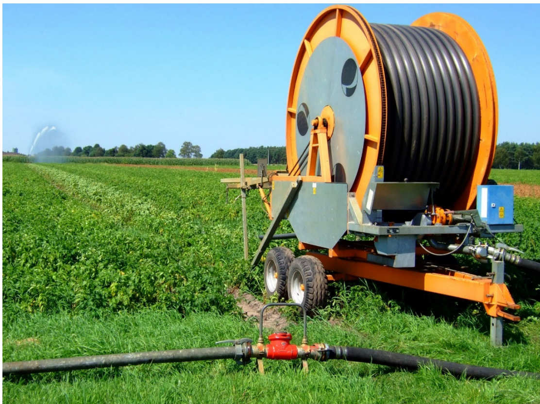
Bild 1: Mobile Beregnungsmaschine mit Großregner und mobilem Wasserzähler am Zuleitungsrohr Figure 1: Mobile irrigation machine with rain gun and mobile water meter on the supply pipe
