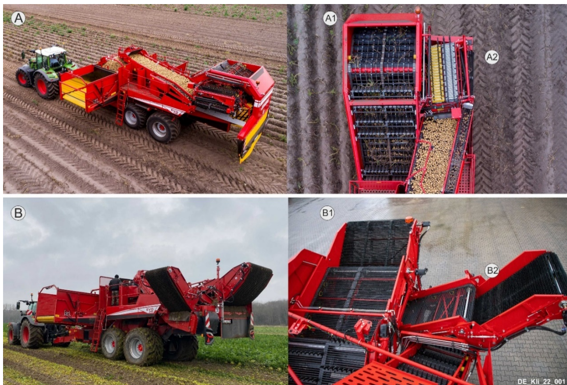
Bild 7: Vergleichende Darstellung einer Kartoffelerntemaschine mit einer MultiCrop Erntemaschine Figure 7: Comparing illustration of a potato harvester with a MultiCrop harvester
