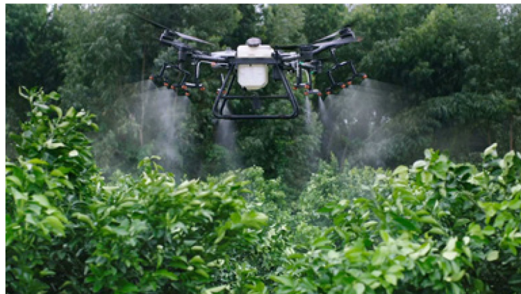
Bild 11: DJI Agras T30 Drohne zum Versprühen von Pflanzenschutzmitteln. [25]
