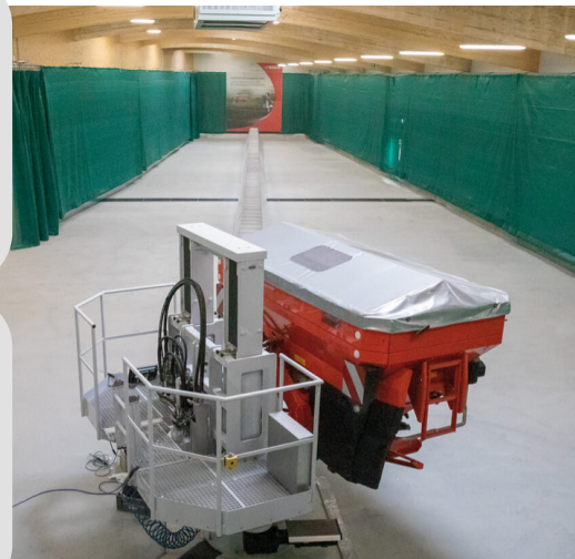
Bild 19: Die aktuell modernste und größte Düngerstreuertesthalle der Welt: Auf 1130 m 2 können insbesondere aktuelle Streutabellen für die Kunden im In- und Ausland erarbeitet werden [RAUCH Landmaschinenfabrik GmbH]
