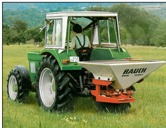
Bild 5: RAUCH-Zweiseibendüngerstreuer ZSN 600 N mit 89 cm Einfüll-Höhe und 600 Liter Behälterinhalt [RAUCH Landmaschinenfabrik GmbH]
