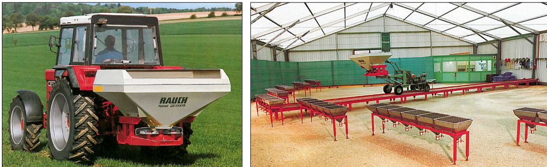
Bild 6: Zweiseibendüngerstreuer ZSB mit Arbeitsbreite bis 24 m (links) und Düngerstreuertesthalle (rechts) [RAUCH Landmaschinenfabrik GmbH]
