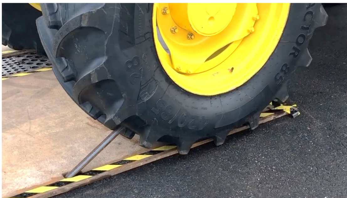
Bild 1: Durchstichtest an einem Ackerschlepper-Reifen mit Agro ContiSeal [2]
