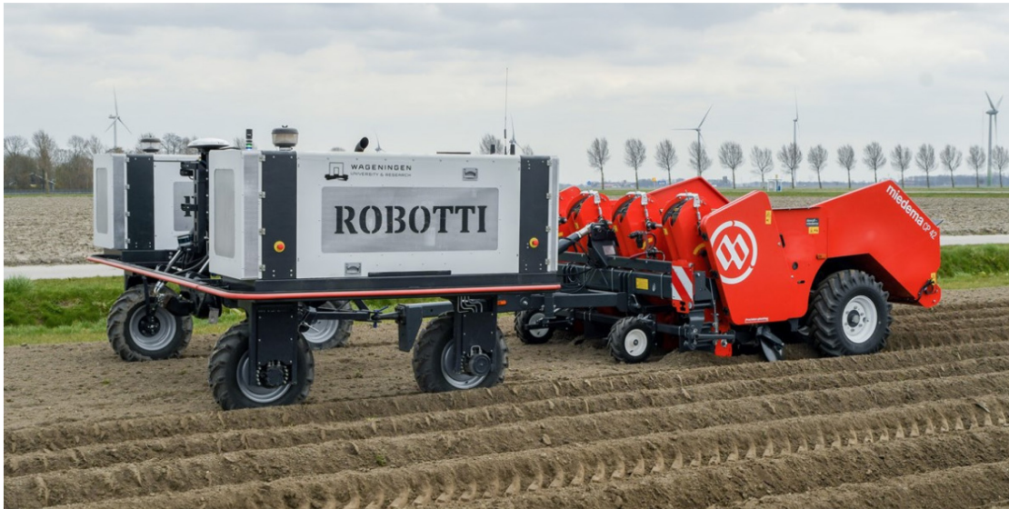
Bild 13: Demonstration eines autonomen Zugfahrzeuges vor einer Kartoffel-Legemaschine [20] Figure 13: Demonstration of an autonomous vehicle in front of a potato planter [20]
