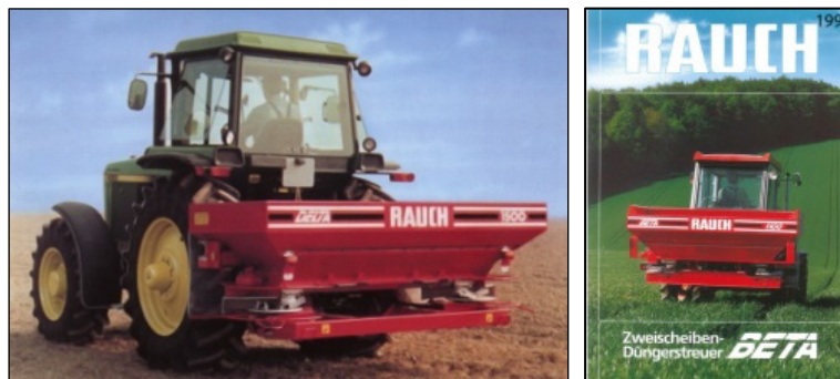
Bild 10: Zweiseibenstreuer DELTA mit hydraulischem Scheibenantrieb und Aufgabepunktverstellung [RAUCH Landmaschinenfabrik GmbH]
