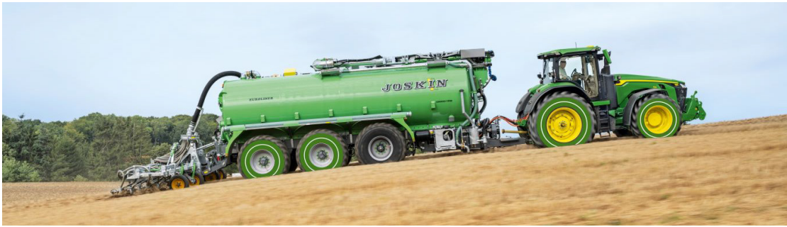
Bild 6: Elektrische Traktion am Güllefass von John Deere und Joskin [27]
