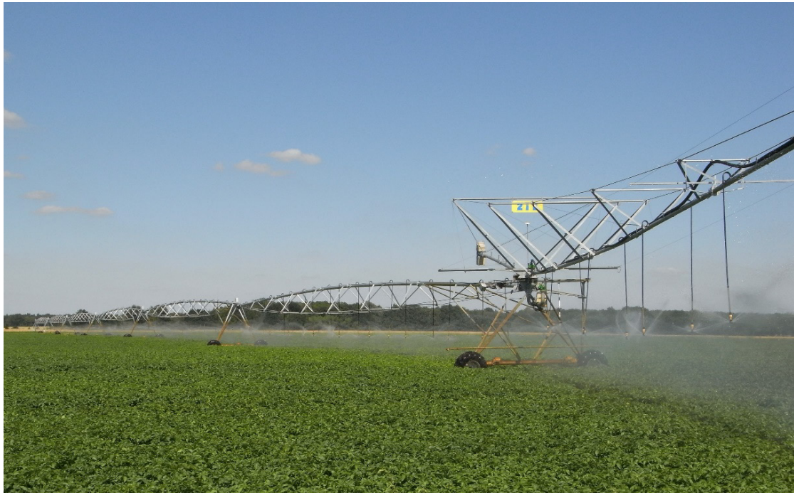
Bild 4: Kreisberegnung mit schwenkbarem Eckenausgleichssystem Figure 4: Pivot irrigation with swiveling corner compensation system
