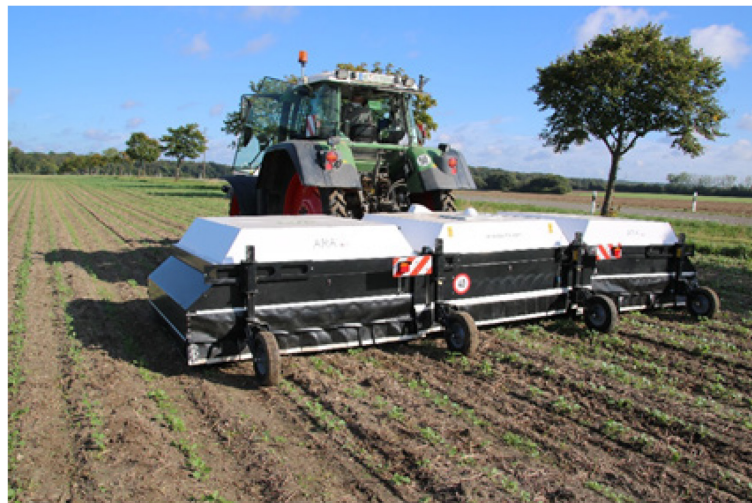
Bild 9: Ecorobotix ARA Anbauspritze mit Pflanzenscanner und 4 cm Düsenabstand. [5]
