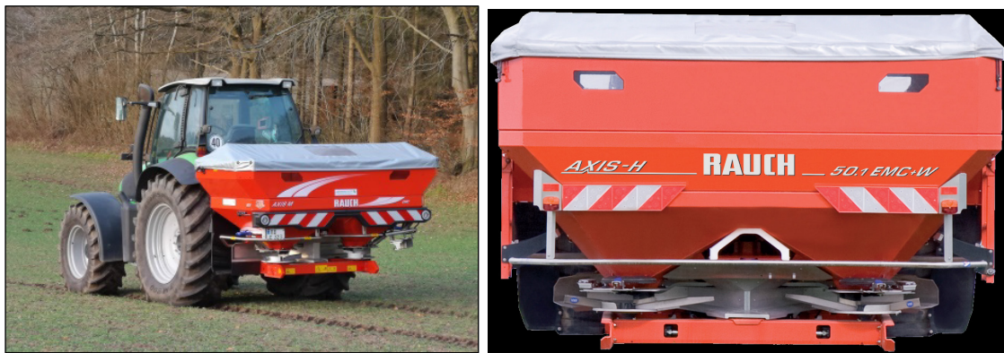
Bild 17: AXIS M mechanischer Scheibenantrieb und Dosiermengeneinstellung (links) und AXIS H-EMC mit hydraulischem Scheibenantrieb (rechts) [RAUCH Landmaschinenfabrik GmbH]
