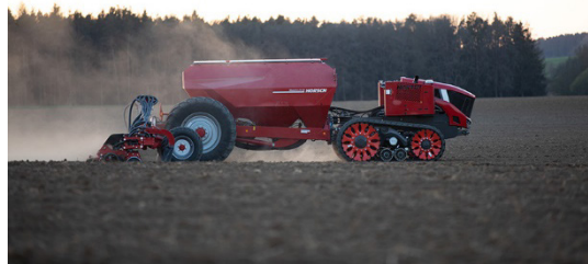
Bild 2: Autonome Zugmaschine von HORSCH bei der Maisaussaat mit 24 Reihen [4]
