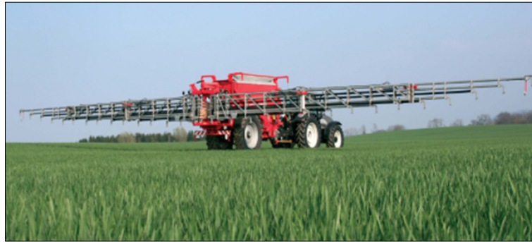
Bild 9: RAUCH Pneumatikstreuer AGT6036, 36 m Arbeitsbreite (2005) [RAUCH Landmaschinenfabrik GmbH]
