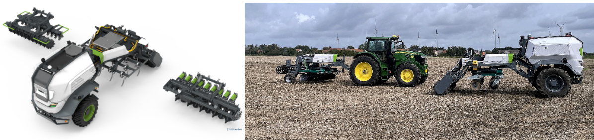
Bild 5: Modulares Konzept. Links: Werkzeugmodule erlauben eine prozessspezifische Konfiguration, Rechts: anstelle des Triebkopfes kann auch ein TIM-kompatibler Traktor benutzt werden
