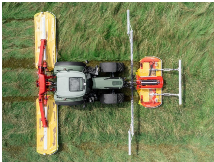
Bild 2: Sensosafe: Sensorbasiertes Assistenzsystem zur Tiererkennung von Pöttinger [6]
