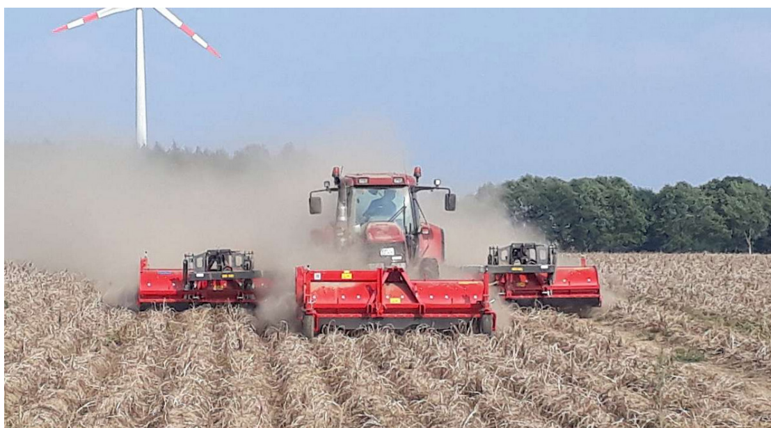
Bild 4: Prototyp / Eigenbaulösung für einen 12-reihigen Krautschläger [7] Figure 4: Prototype / self-made solution for a 12-row haulm topper [7]
