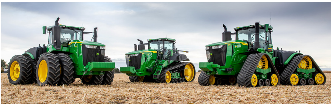
Bild 2: Neueste 9R-Generation von John Deere mit drei verschiedenen Fahrwerksvarianten
