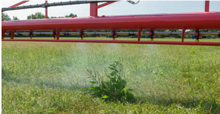
Bild 8: Agrifac Camera sprüht „green on green“. [19]
