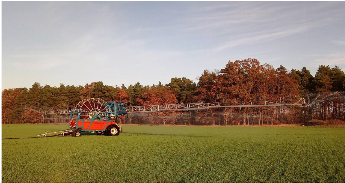
Bild 2: Düsengestänge an selbstfahrender Beregnungsmaschine Figure 2: Nozzle boom on self-propelled irrigation machine
